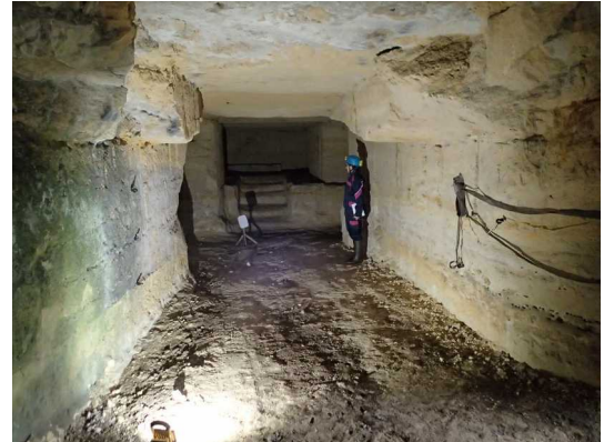
Illustration 3: Début des mesures à l'entrée (Stations E1 → E2). Remarquer l'éclairage d'appoint avec le projecteur LED
